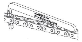
3.Le guide d'usure de chaînes Renold mesure l'allongement de la chaîne en incréments de 0.5%. L'usure totale est celle indiquée entre 2 rouleaux de la chaîne.
